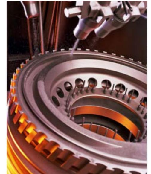
Geführtes Kugelstrahlen zur Bearbeitung eines Turbinenlaufrades (Quelle: <http://www.kugelstrahlen-shotpeening-mic.de/cms/luftfahrt.html>)
