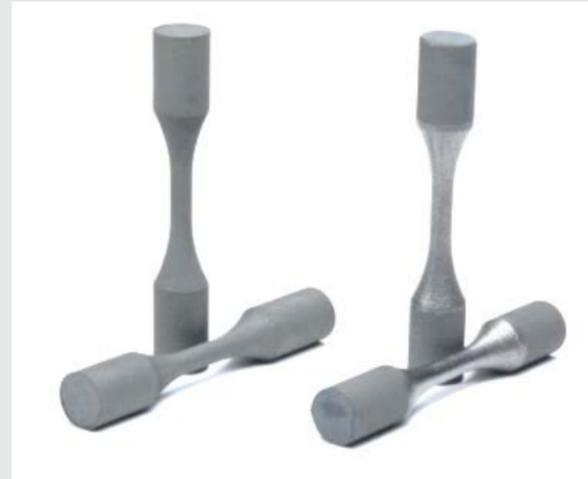
Unbehandelte (links) und behandelte (rechts) Dauerschwingproben des Kugelstrahlens
