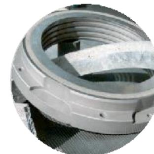
Zwischenflansch einer Verzahnungsmaschine (mit eingeklebtem Metallschaumring)
